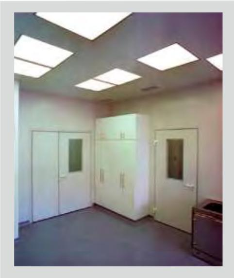
Перегородки конструируются из панелей - плит с вертикальным установочным каналом (стойкой) 120 мм между каждым элементом. Панели изготавливаются из оцинкованного стального листа толщиной 0,75 мм. Толщина слоя цинка зависит от предназначения отдельных частей. В основном, используется стальной лист с покрытием 250 гр. Zn/м<sup>2</sup>.
