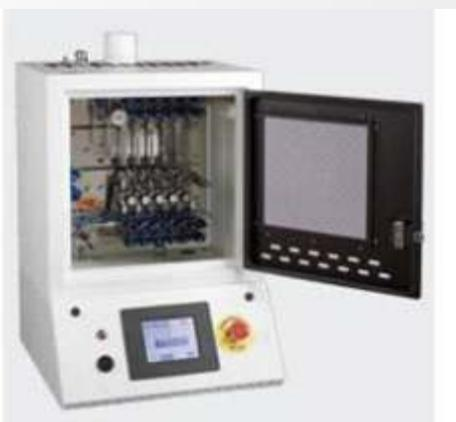
обеспечения возможности управления индивидуальной газовой линией потребителя без влияния на характеристики основной линии подачи газа. Состав компонентов газораспределительной панели определяется требованиями Покупателя и может включать запорные клапаны, редукторы, манометры, фильтры/осушители для обеспечения подачи газа от одного источника различным потребителям с разным давлением и расходом.
